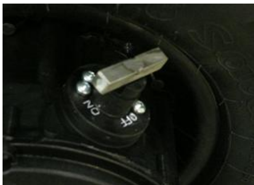
Abb. 3 – Einschaltung der Rekuperation – der Elektroenergiegewinnung
